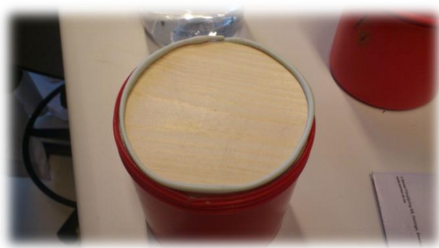
Figur 3.2, tätning med häftmassa.
