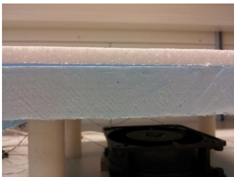
Figur 3.5 (t h), huven ovanpå ramen av cellplast.
