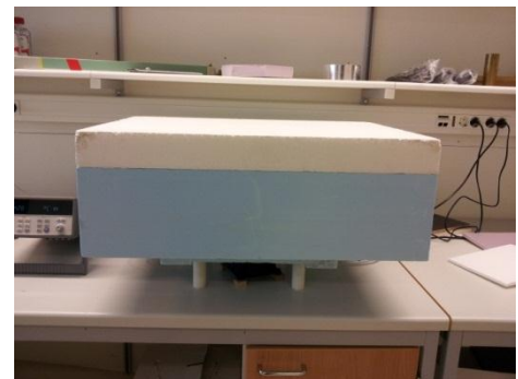
Figur 3.5 (t h), huven ovanpå ramen av cellplast.
