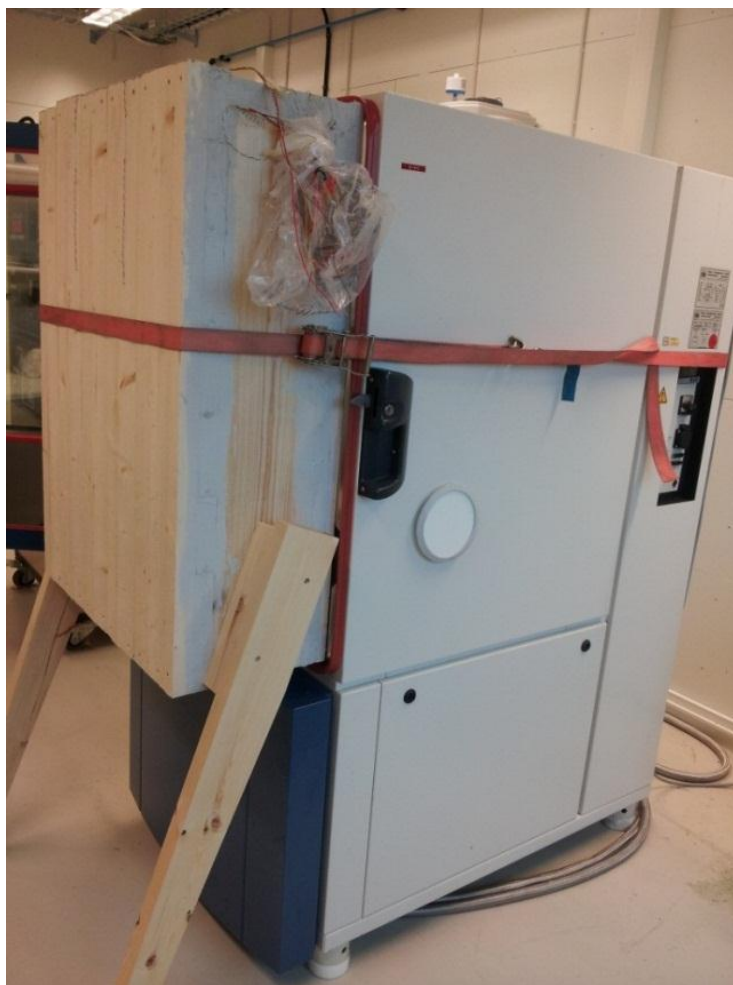
Figur 4.1, provväggen uppmonterad mot klimatskåpet.
