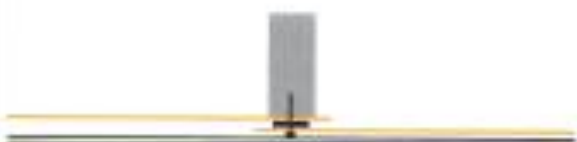
Figur 15: Skarvning mellan de lufttöta skikten sker genom dubbelhäftande tätningsband.
