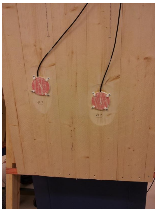
Figur 4.19, Värmeflödesmätarna placerade på provväggen.
